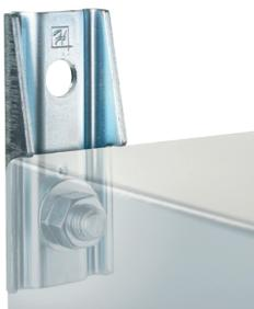
Der Satz ist vor Ort montierbar. Die Edelstahlwinkel entsprechen Typ 4X. Ein Satz bestehend aus vier Winkeln ist für eine Last von bis zu 220 kg ausgelegt. Alle Befestigungselemente sind inbegriffen. Vier Winkel pro Satz.
