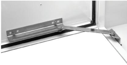
Ausgelegt für die Verwendung mit den meisten großen Standardgehäusen aus Bau- und Edelstahl zur Arretierung der Tür in einem 90-Grad-Winkel. Der Türarretierungssatz kann oben oder unten an der Türöffnung montiert werden. Dazu müssen lediglich jeweils zwei kleine Löcher in das Schrankgehäuse und in die Tür gebohrt werden. Alle Teile sind beschichtet. Erfüllt bei sachgemäßer Montage in einem Hoffman-Gehäuse UL/CSA Typ 4 und Typ 12.
