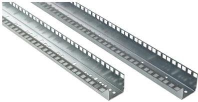
Winkelprofile mit Rechteckbohrungen bestehen aus 2,0 mm starkem, beschichtetem Stahl und können mit metrischen oder englischen Käfigmuttern montiert werden. 19-Zoll-Winkelprofile werden direkt an einem 600 mm breiten Gestell befestigt. Verwenden Sie für die Montage von 19-Zoll-Winkelprofilen in 800 mm breiten Gestellen-Reduzierwinkel. Verwenden Sie für die Montage von 19-Zoll-Winkelprofilen in 1200 mm breiten Gestellen Tiefenstreben.
