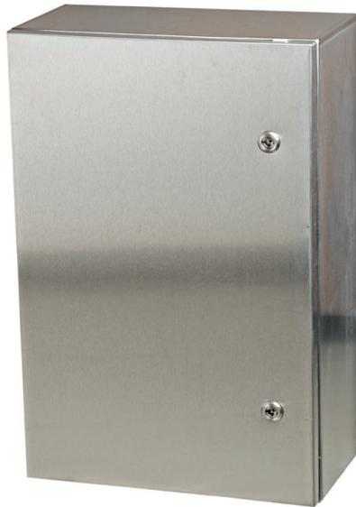
Diese Gehäuse aus Edelstahl 304 und 316L sind ideal für Indoor- und Outdoor-Anwendungen, bei denen ein Korrosionsschutz gegen Chemikalien und Wasser erforderlich ist. Sie verfügen über eine robuste Tür mit abnehmbaren Scharnieren und einem Vorreiberverschluss mit 3-mm-Doppelbart zum sicheren Verschließen. Ein nach außen gewölbter Gehäuseflansch verhindert, dass Verunreinigungen in das Gehäuse gelangen. Eine leitfähige Platte ist separat erhältlich
