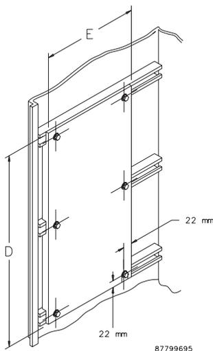
Montageplatten bieten seitlich im Gehäuse eine zusätzliche Montagefläche.
